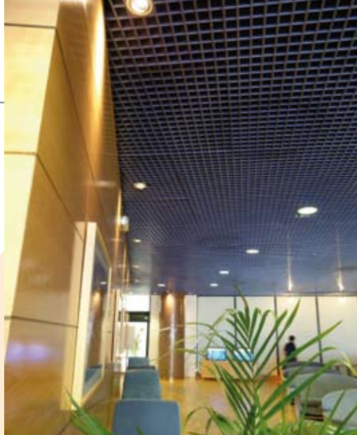
En las salas VIP de la T1 y la T3, 300 lámparas halógenas dicroicas de 50W han dejado paso a lámparas LED Toshiba de 8.5W.
